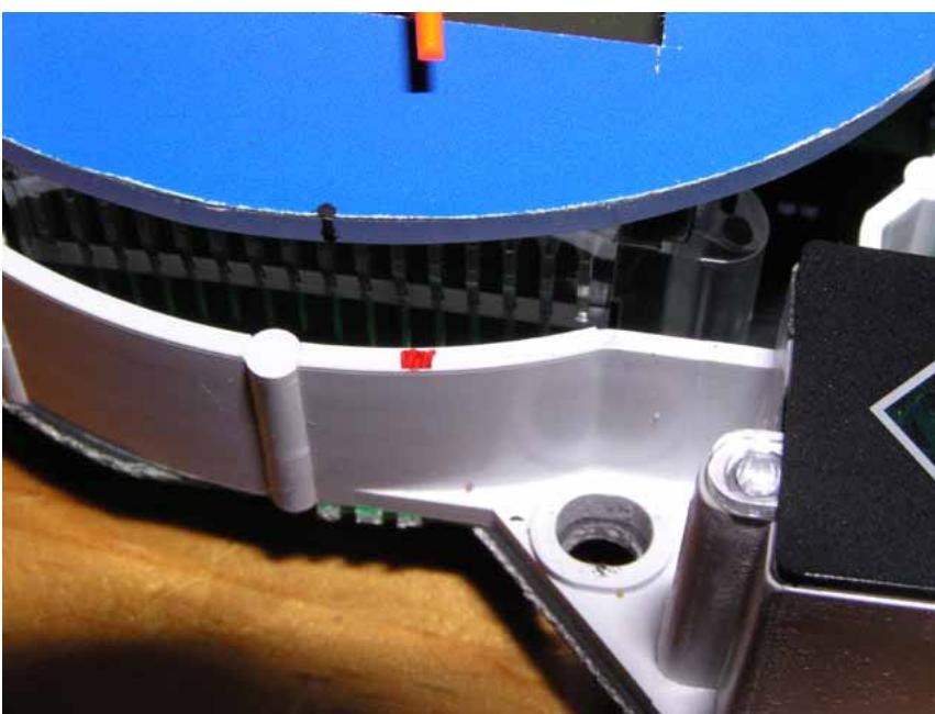
Photo 1 : Positionner délicatement l'aiguille vers le 160
