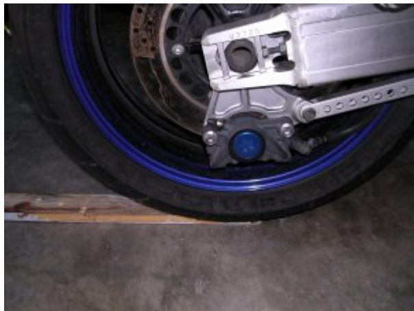
ensuite on mesure l'entaxe entre la fixation du b.oscillant et la fixation de la biellette de progressivité (entraxe origine=142mm - 6mm=136mm) dans mon cas.La g.au sol augmente de 2 cm,le cul 3 à 4 cm).Puis reporter ce nouvel entraxe sur la plaque d'alu et tracer les nouvelles biellettes en s'aident des anciennes pour les arrondis.
