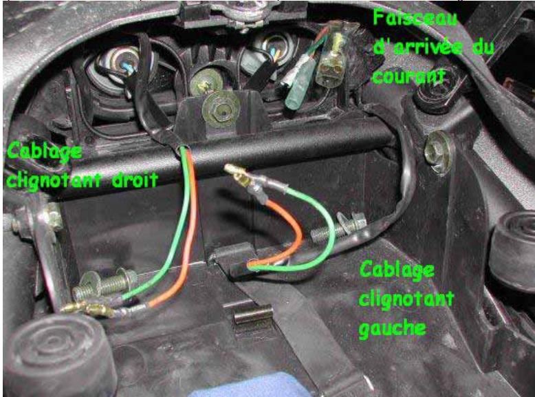
Le faisceau d'arrivée du courant est fixé sur la gauche par un collier que l'on doit détacher afin de libérer la longueur du fil. Débrancher les fils.
