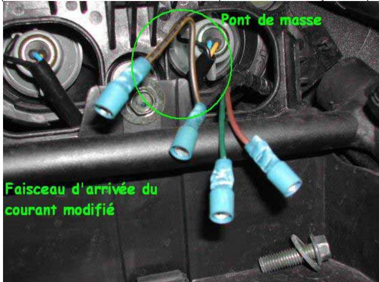
Retirer ensuite les clignotants avec leur faisceau, et remplacer également les cosses d'origine.
