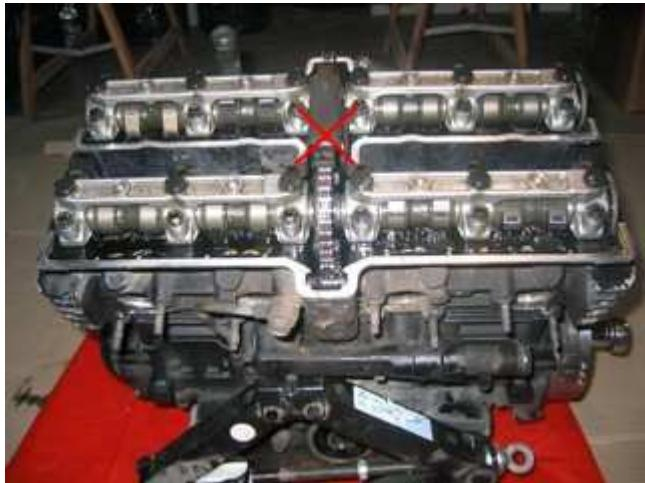
A l'aide d'une clé à œil de 10 desserrer (ne pas déposer) les 4 boulons du pignon de l'arbre à cames « 2 »
