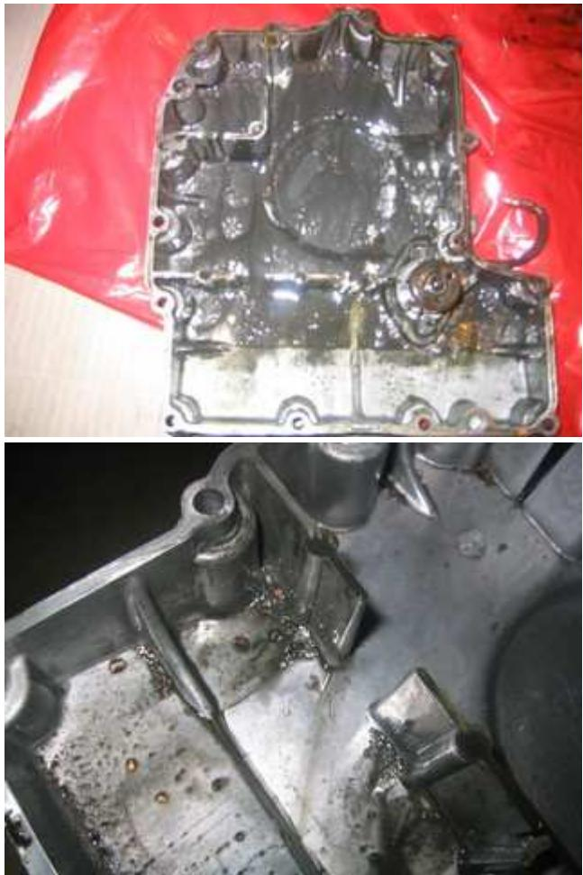
Déposer en tirant dessus la soupape de décharge, nettoyer, vérifier changer le joint torique puis remettre en place
