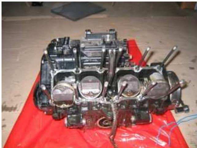
Je vérifie maintenant le diagnostique de mon cons Yam en prenant un par un mes pistons en main et en vérifiant le jeu ( de haut en bas) .....Put..., le piston 4 ( a gauche sur la photo) a un jeu d'au moins 5 mm, le coussinet est bien HS
