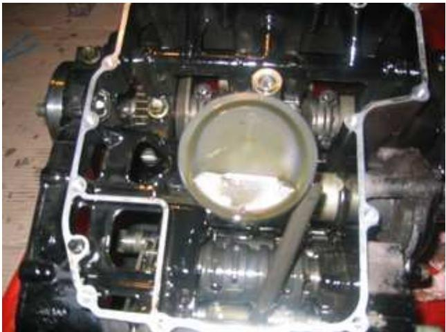
Déposer les 19 vis du carter inférieur + les deux de la Plaque de butée de joint à lèvres dans l'ordre expliqué ci dessous.
