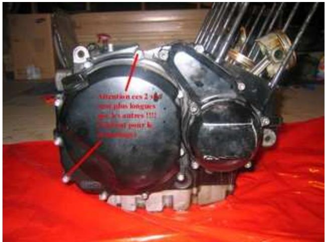
A l'aide d'une clé de 10 Desserrer les 6 vis (commencer par les dévisser de quelques tours chacune avant de les déposer complètement
