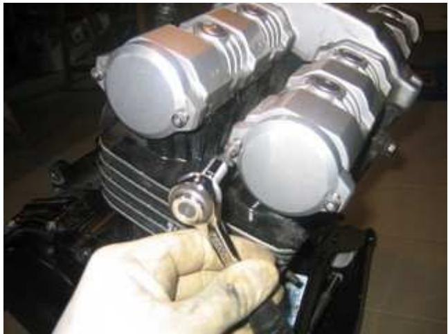
A l'aide d'une clé BTR de 5 retirer les 8 vis du cache soupape.
