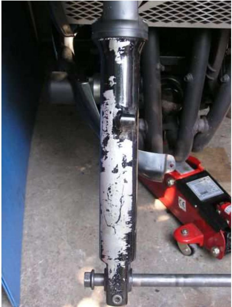
j'ai donc demonté les 2 tubes , j'en ai profité pour faire la vidange des tubes de fourche , bizarrement les ressorts etaient à l'envers !!!! 😱😱 bref...remis a l'endroit.....
