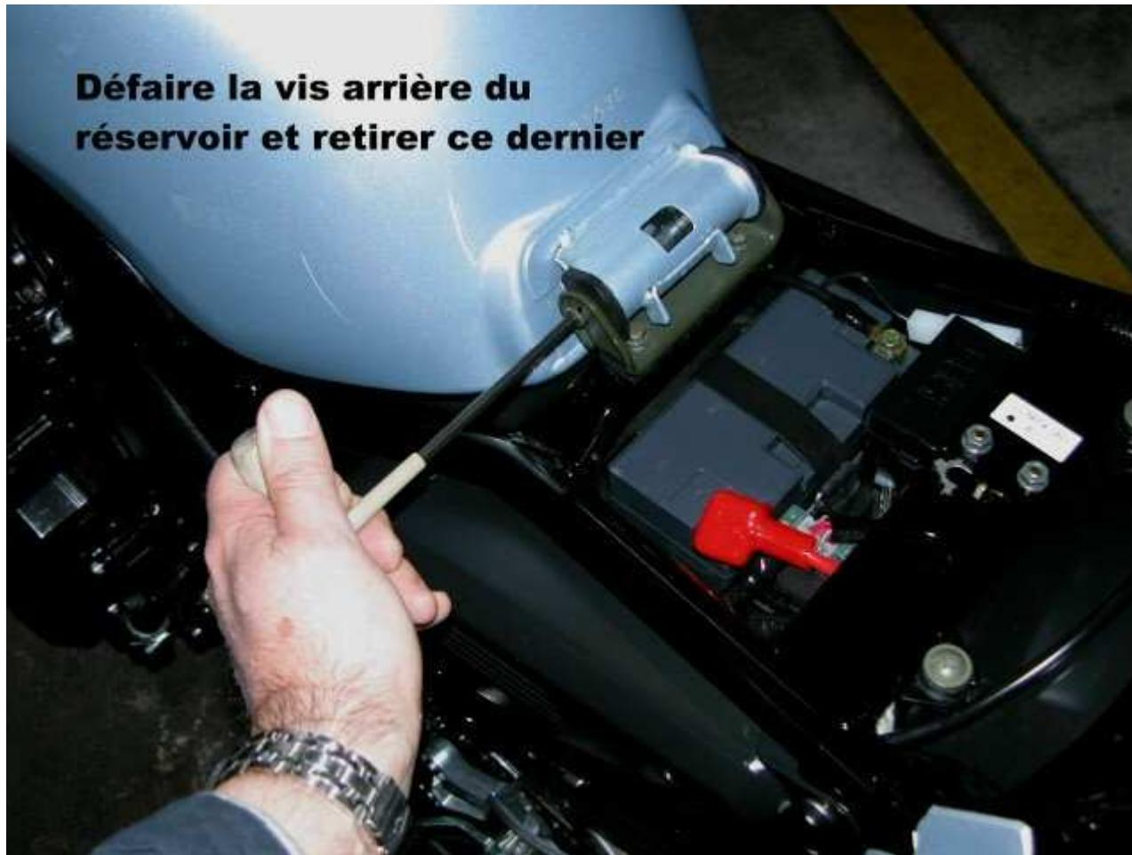
poser le réservoir au sol sur un chiffon afin de ne pas risquer de l'âbimer puis:
